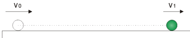
Abbildung 4.20: Versuchsanordnung zur Bestimmung des Rollreibungskoeffizienten
