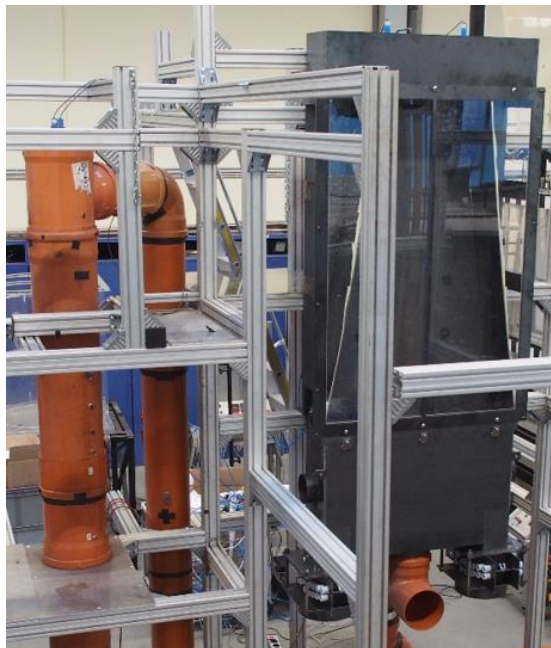
Abbildung 4: Konstruktionen für die Versuchsdurchführung. Links: Versuchsrohr, Rechts: Schachtmodell
