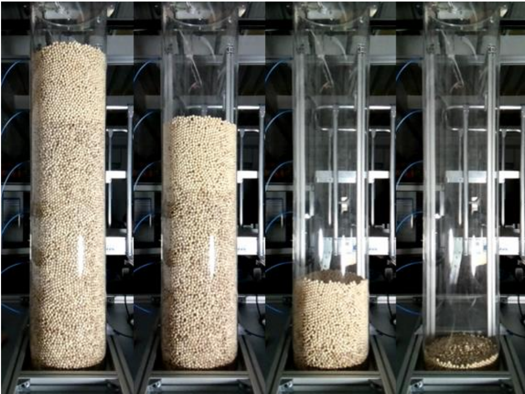
Abbildung 38: Auslaufversuch ohne Durchströmung zu verschiedenen Zeitpunkten
