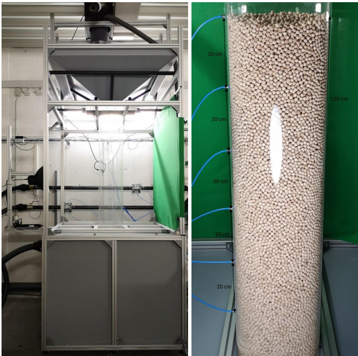
Abbildung 20: Fotografie des leeren (links) und mit Holzkugeln gefüllten Versuchssilos (rechts)
