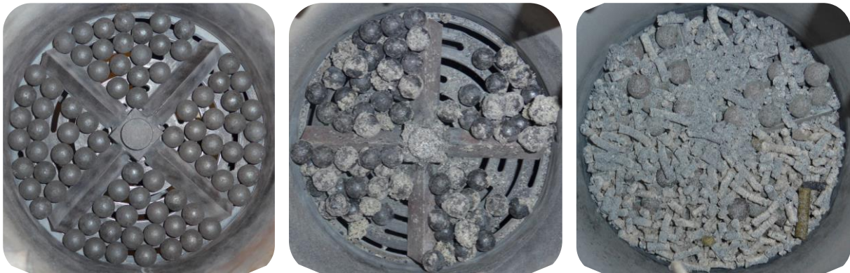
Abbildung 4.51: Brennerkopf vor den Kugelschichtversuchen (l.) und nach den Kugelschichtversuchen bei einer Drehzahl von 0,84 min -1 (VP3) (m.) und 4,82 min -1 (VP4) (r.).
