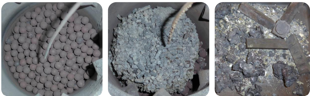
Abbildung 4.56: Brennertopf nach dem Versuch mit einer Drehzahl von 4,82 \text{ min}^{-1} (VP5) (l.) und mit einer Drehzahl von 1,34 \text{ min}^{-1} (VP6) (m.) sowie geschmolzene Kugeln und zerstörter Rührer nach einem Vorversuch mit einer Drehzahl von 0,84 \text{ min}^{-1} (r.).
