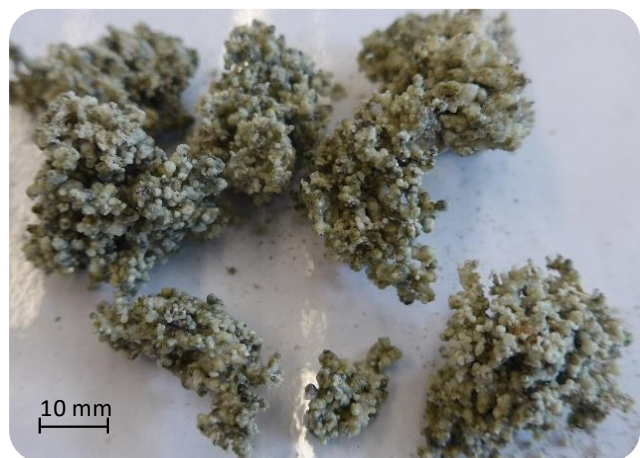
Abbildung 4.43: Ansammlung der Pelletasche im Brennerkopf (l.) und Nahaufnahme typischer versinteter Aschestrukturen aus dem Brennerkopf (r.) nach dem Referenzversuch (VP1).
