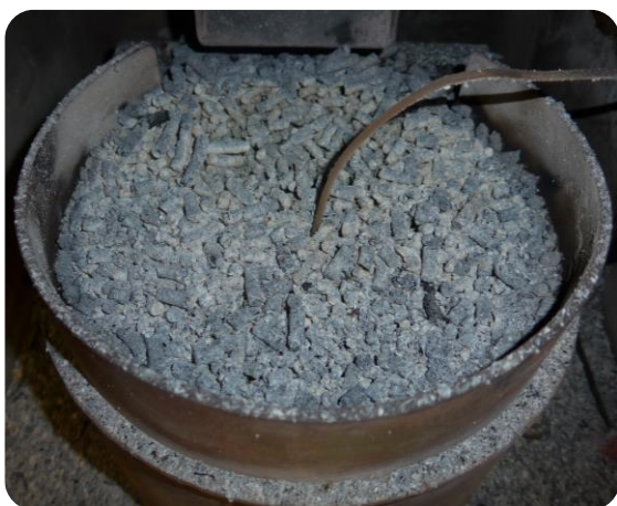
Abbildung 4.43: Ansammlung der Pelletasche im Brennerkopf (l.) und Nahaufnahme typischer versinteter Aschestrukturen aus dem Brennerkopf (r.) nach dem Referenzversuch (VP1).
