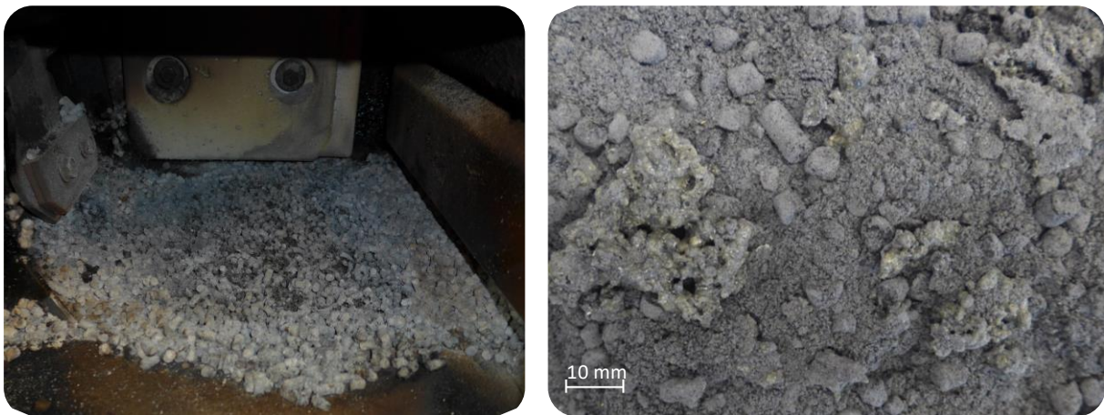
Abbildung 4.74: Bildaufnahme der verbliebenen Pelletasche (l.) auf dem Wanderrost und der durch die Ascheschnecke ausgeförderten Pelletasche (r.) von Versuch VK3.
