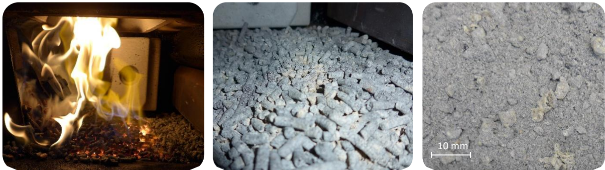
Abbildung 4.71: Bildaufnahme während der Verbrennung der Pellets (l.), der verbliebenen Pelletasche (m.) auf dem Wanderrost und der durch die Ascheschnecke ausgeförderten Pelletasche (r.) beispielhaft zu Versuch VK1.
