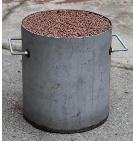
Abbildung 26: Messzylinder für die Schüttdichtemessung
