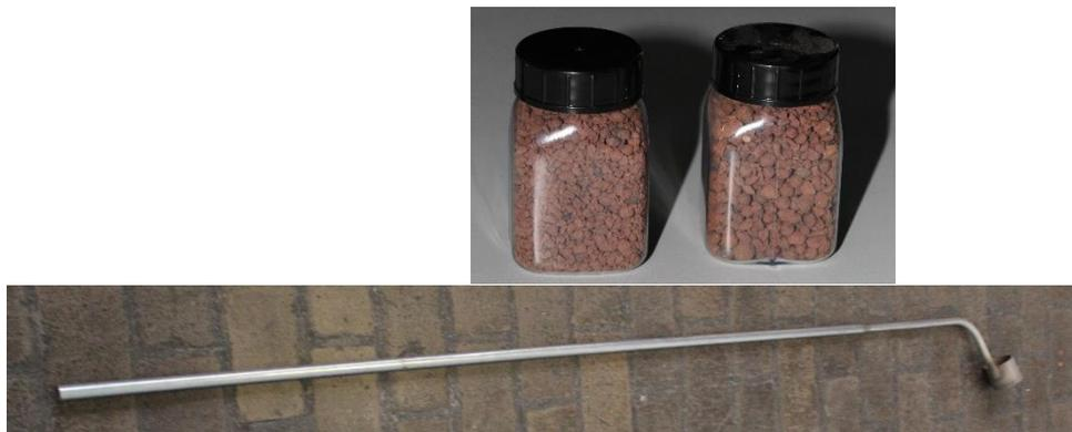
**Abbildung 42: Probenbehälter (oben) und Stange zur Probeentnahme (unten)**
