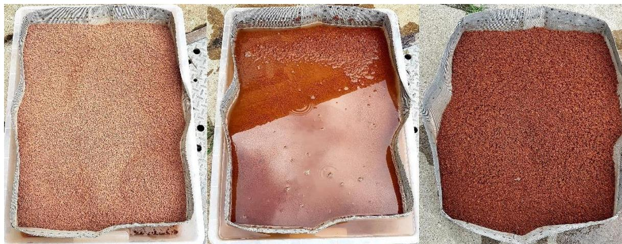
**Abbildung 41: Befeuchtung des Blähtons im Gitterbehälter; trockener Blähton (links), Blähton im Wasserbad (mitte) und abtropfender Blähton (rechts)**
