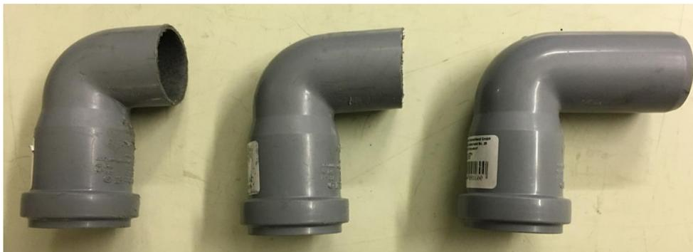
**Abbildung 29: Verschiedene Endstücke der Zulaufleitung**
