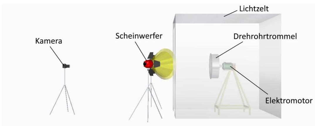
**Abbildung 45: Apparativer Aufbau der Versuchsanlage zur Untersuchung der transversalen Bewegung**
